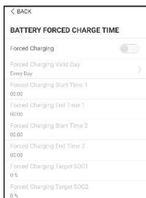
figure 8-21 Temps de charge forcée de la batterie
