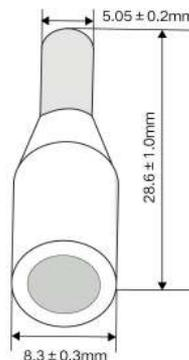
Retirez l'isolation du câble CC d'environ 18 à 20 mm à l'aide d'une pince à dénuder. Insérez le câble dénudé dans la borne pressée à froid et sertissez-le à l'aide d'une pince à sertir.
