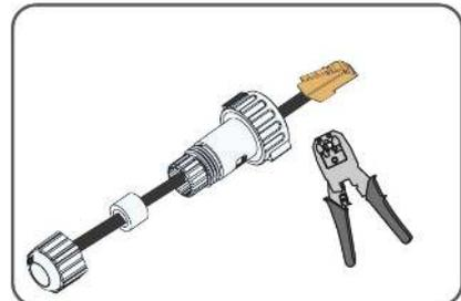
4. Remettez la rondelle en caoutchouc, puis serrez le boulon.
