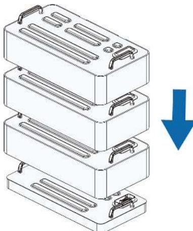
Ne basculez pas le PACK d'un côté pendant l'installation.
