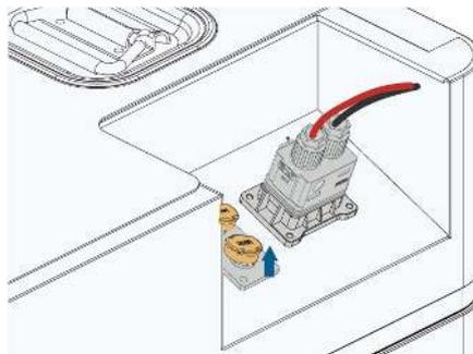
2. Insérez le câble de communication et la résistance de terminaison respectivement dans les ports OUT et IN de la borne de communication, en vérifiant qu'ils « s'enclenchent » en place.
