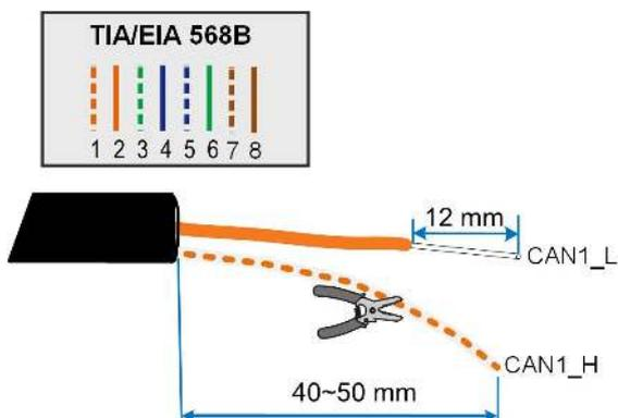
3. Insérez les fils dénudés dans les bornes pressées à froid correspondantes et sertissez-les à l'aide d'un outil de sertissage.
