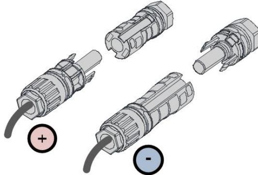
6. Tirez doucement les câbles CC vers l'arrière pour vérifier si le branchement est sécurisé.
