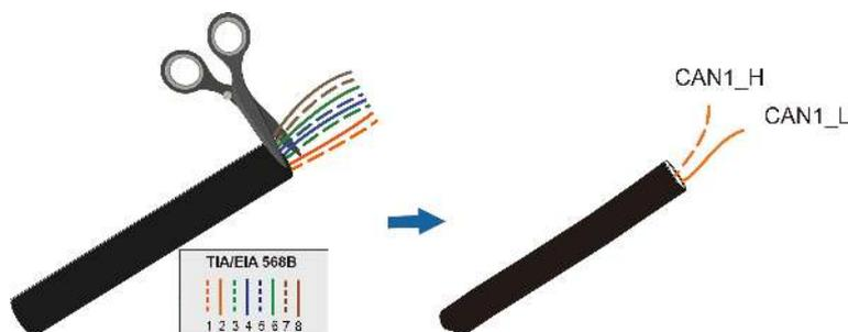
2. Retirez l'isolation des deux câbles de signal sur 12 mm.
