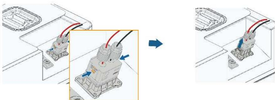
4. Desserrez l'élément de verrouillage du connecteur côté onduleur, à l'aide d'une clé de démontage et installez le bouchon étanche.
