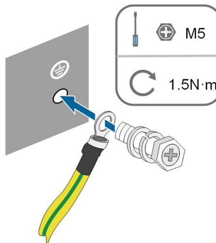
3. Appliquez du silicone ou de la peinture sur la borne PE pour la protéger de la corrosion.
