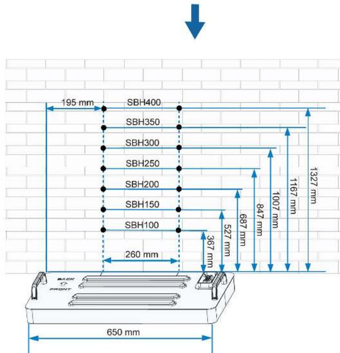
Lignes de référence pour le perçage des trous : utilisées pour déterminer l'espacement entre les deux trous aux extrémités du support de fixation de la batterie.
