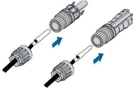
5. Installez les écrous orientables sur les connecteurs et serrez-les. Tirez doucement les câbles vers l'arrière pour vérifier que le branchement est sécurisé.
