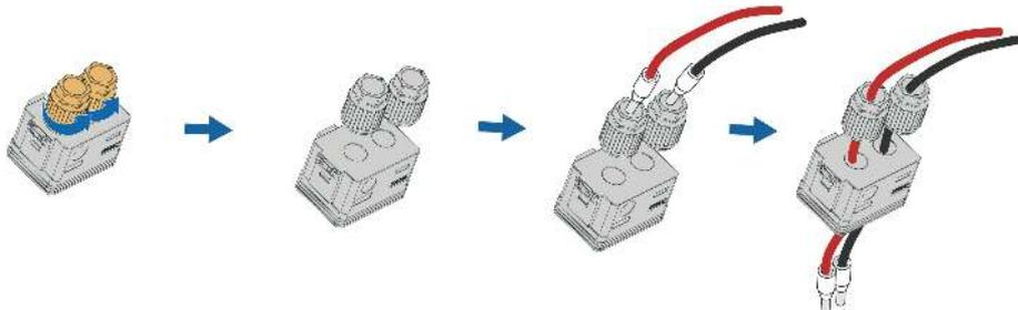
3. Insérez le tournevis plat directement dans le port CDC et appuyez sur le tournevis. Les bornes de câble peuvent maintenant être insérées dans les ports correspondants. Relâchez la pression sur le tournevis. Les câbles CC seront automatiquement sécurisés.
