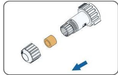
2. Faites passer le câble de communication à travers le connecteur de communication et retirez l'isolation du câble d'un côté d'environ 10 à 15 mm.
