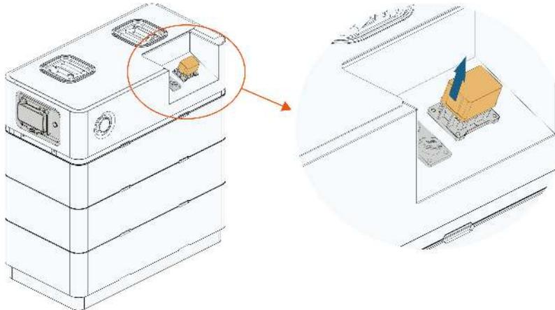
2. Faites passer les câbles CC côté batterie à travers le connecteur d'alimentation.
