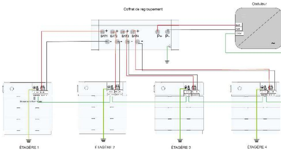
figure 5-2 Schéma de la cascade de batteries
