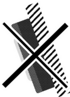
Ne montez jamais le Sun Ô-Gr1 avec une inclinaison vers l'avant
