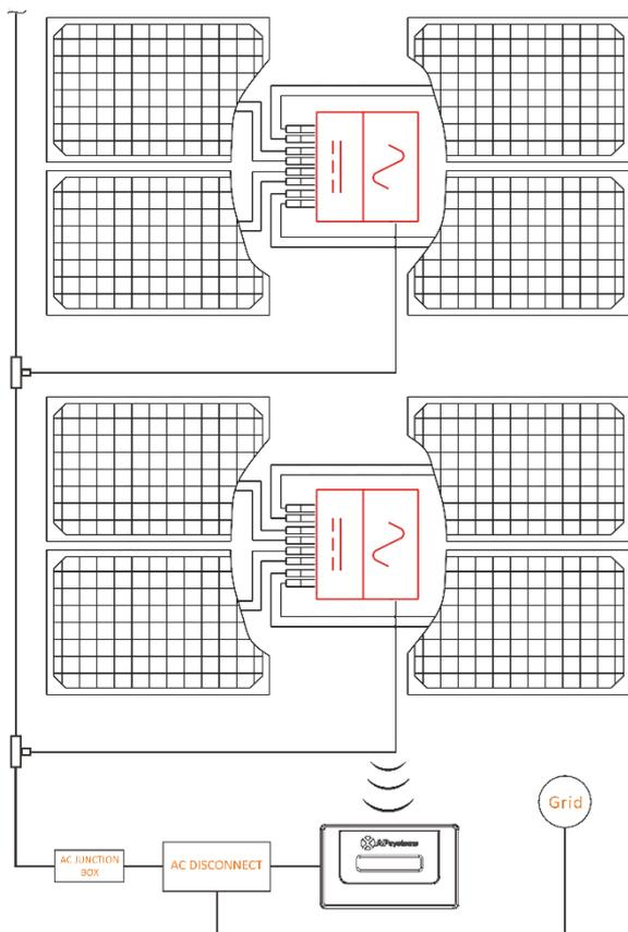
L'YC1000 est le premier micro-onduleur solaire natif 3-phase, conçu pour fonctionner parfaitement sur un réseau triphasé de 230/400 avec une puissance de sortie maximale à 1130 watts AC. Chaque YC1000 communique via une antenne ZigBee à La passerelle ECU et raccorde 4 modules PV tout en gardant les bénéfices d'une gestion et d'un monitoring par panneau.
